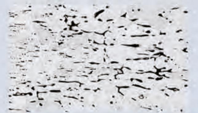
Übergangsbereich zwischen dem Gefüge des Grundstoffs und dem Gefüge der thermisch belasteten Elektrodenspitze.
