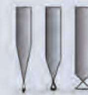
Einbrandprofile in Abhängigkeit vom Spitzenwinkel.
