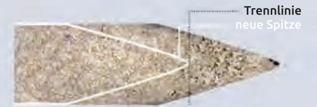
Mikrostruktur der Elektrodenspitze nach Einsatz.
