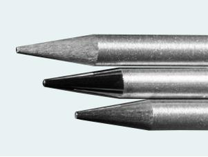
1. Elektroden sortieren; Aufbereiten und Schleifen nach Vorgabe
