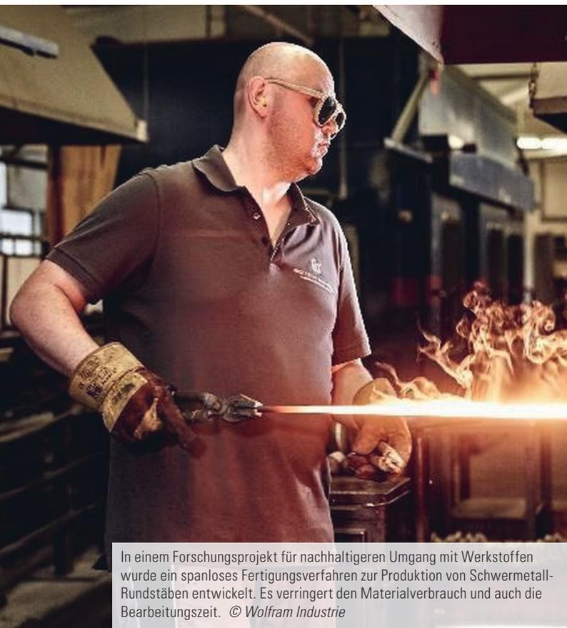
In einem Forschungsprojekt für nachhaltigeren Umgang mit Werkstoffen wurde ein spanloses Fertigungsverfahren zur Produktion von Schwermetall-Rundstäben entwickelt. Es verringert den Materialverbrauch und auch die Bearbeitungszeit. © Wolfram Industrie
