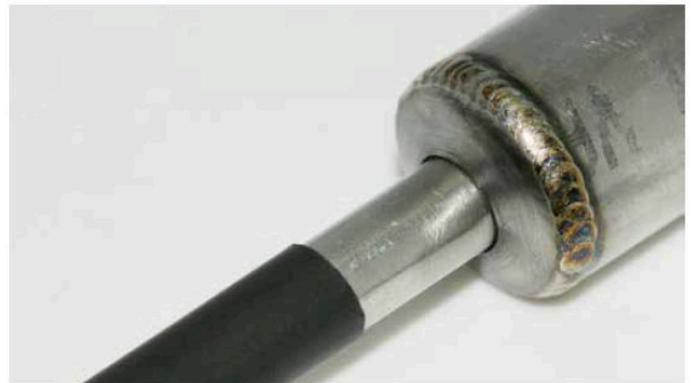
*Bei Werkstücken mit einer Materialstärke von bis zu 0,1 mm entstehen qualitativ hochwertige Schweissnähte oder Schweisspunkte für die feinen Geometrien, ohne einen thermischen Verzug zu produzieren, unerwünschte Farbanläufe zu generieren oder strukturelle Veränderungen im Metallgefüge in Kauf nehmen zu müssen.*
