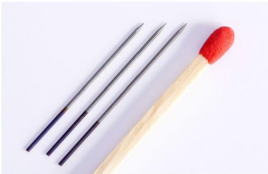
▲ Bild 4. Bei der Entwicklung der Elektrode wurde unter dem Mikroskop mit chirurgischen Werkzeugen wie Nadelhaltern gearbeitet, da die kleinen WIG-Elektroden nur einen Durchmesser von etwa 0,6 bis 1,0 mm haben.
