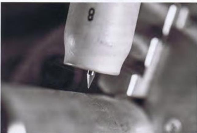
Wolframelektroden werden häufig bei Schweissarbeiten verwendet, aber deren Aufbau, Anschlag und Legierung besitzen beim WIG-Schweissen einen bisher unterschätzten Einfluss auf ein konstant gutes Produktresultat. Nur bei einer ausgezeichneten Elektrodenqualität und -geometrie ist eine reproduzierbare Schweissnaht möglich.
