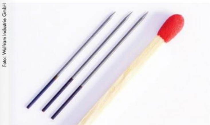
Bei der Entwicklung der PUK-Star wurde unter dem Mikroskop mit chirurgischen Werkzeugen wie Nadelhaltern gearbeitet, da die kleinen WIG-Elektroden nur einen Durchmesser von etwa 0,6 bis 1,0 mm aufweisen. Auf diesem Bild ist ein Vergleich mit einem Streichholz zu sehen.
