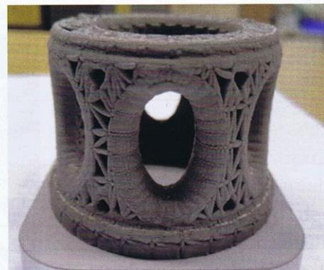
Solch präzise und teilweise geschwungene Formen komplexer Bauteile sind unmöglich mittels herkömmlicher, spanender oder umformender Bearbeitungstechniken aus dem harten Schwermetall modellierbar, dessen extrem hoher Schmelzpunkt zwischen 3387 und 3422 °C liegt / Such precise and sometimes curved shapes are impossible to form from the hard heavy metal, whose extremely high melting point is between 3387 and 3422 °C, using conventional machining or forming processing techniques
